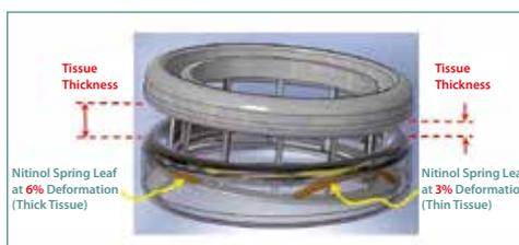
**Abb. 5: ColonRing™: superelastische Nitinolfedern ermöglichen einen konstanten Kompressionsdruck in einem Deformierungsbereich von 1-6%. Dadurch soll eine Anpassung an unterschiedlich dickes Gewebe ermöglicht werden.**
